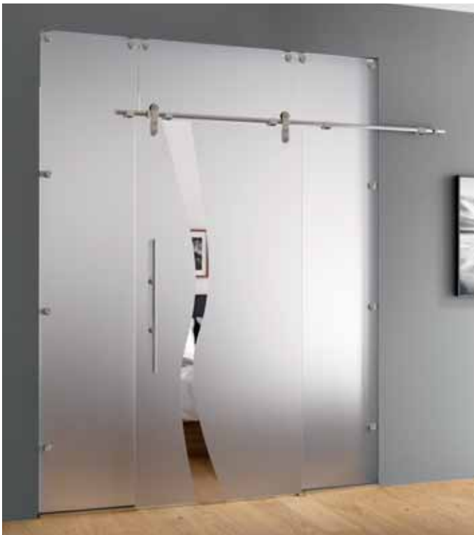
↑ Glasschiebeanlage Typ 2 | Schiebesystem Edition Basic, Edelstahl matt Seitenteil und Oberlicht: Satinato | Glasdesign: Wave Typ 8, Motiv klar/Fläche matt L&H Griffstange G 700 rund
