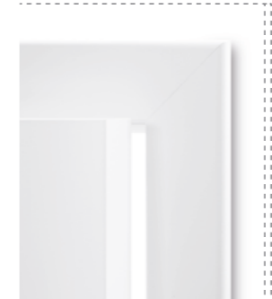
Türblatt TB-STU Stumpfe Kante Zarge FU-RF / STU Bekleidung rund (60/16 mm und 80/22 mm) Futterplatte rund Feuille de porte TB-STU Chant plat Châssis FU-RF/STU Chambranle arrondi (60/16 mm et 80/22 mm) Ébrasement arrondi
